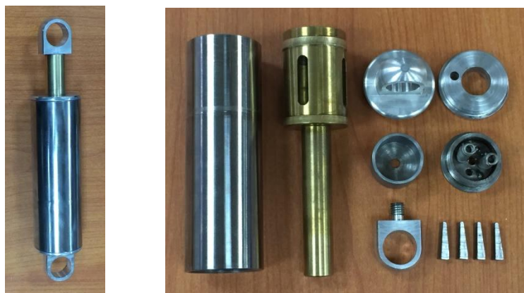
Hình 3.5: Giảm chấn SMA mẫu và các bộ phận của giảm chấn.
