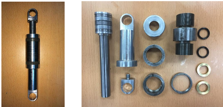
Hình 4.6: Giảm chấn MRF mẫu và các bộ phận của giảm chấn.
