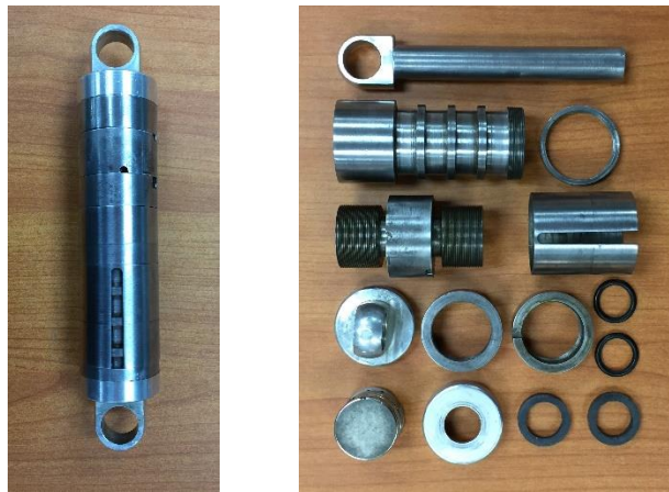
Hình 5.10: Giảm chấn mẫu 4 cuộn dây và các bộ phận của giảm chấn.
